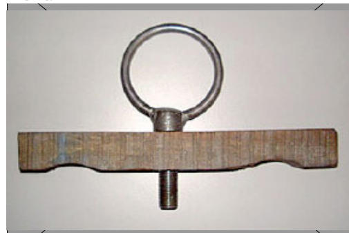
Ösenschraube mit Querholz zum Einheben der Hydraulikeinheit in die Kassette / Eye screw with wooden cross bar to insert the cylinder unit into the cassette
