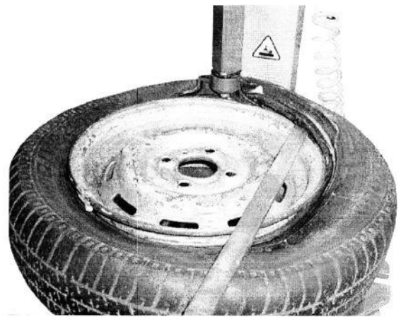
Nr. 11 Når dækket er trukket over monteringshovedet tryk på pedal nr. 19, så drejepladen rotere.
