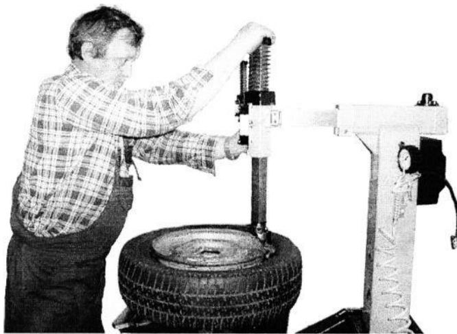
Nr. 8 placering af glider og monteringshoved
